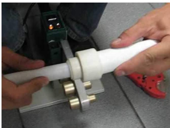
Рис. 3. З'єднання за допомогою нагрівання
